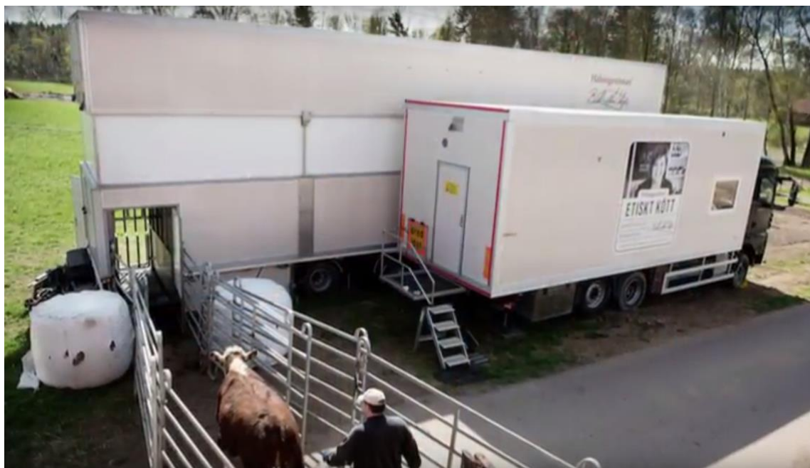
MSE voor runderen in Zweden. Let op het uitschuifbare dakdeel van de achterste wagen (bron: www.halingestintan.se )
